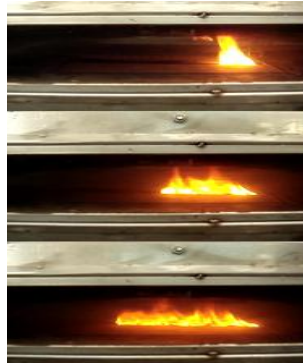
Σχήμα 3. Χαρακτηριστικά στιγμιότυπα μετατόπισης φλόγας σε καλώδια
