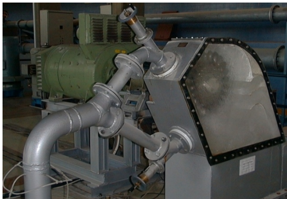
Σχ. 1α. Πειραματικό μοντέλο Υδροστροβίλου Pelton εργαστηρίου
