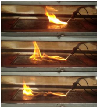
Σχήμα 2. Χαρακτηριστικά στιγμιότυπα μετατόπισης φλόγας σε πάνελ οροφής
