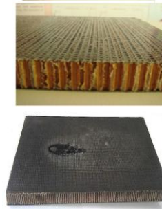
Σχήμα 4. Πάνελ οροφής πριν και μετά τη καύση
