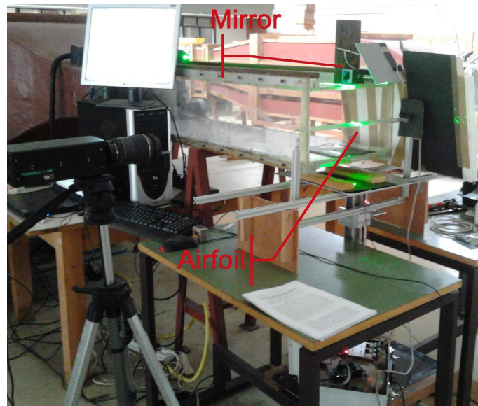
Σχ.1 Μετρητική διάταξη κινούμενης αεροτομής
