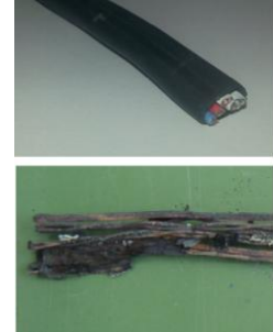
Σχήμα 5. Καλώδια πριν και μετά τη καύση
